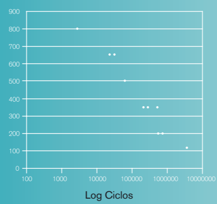
Figura 7. Curva de fatiga resultante.
