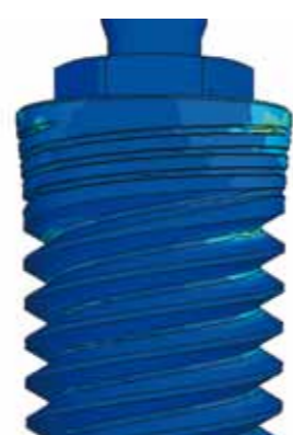
Figura 15b. Distribución de la tensión equivalente para los casos 2 (A) y 3 (etapas intermedia y final de las consideradas) en el implante.
