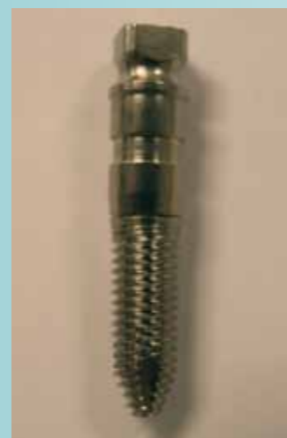
Figura 5. Implante con dispositivo para los ensayos de torsión.
