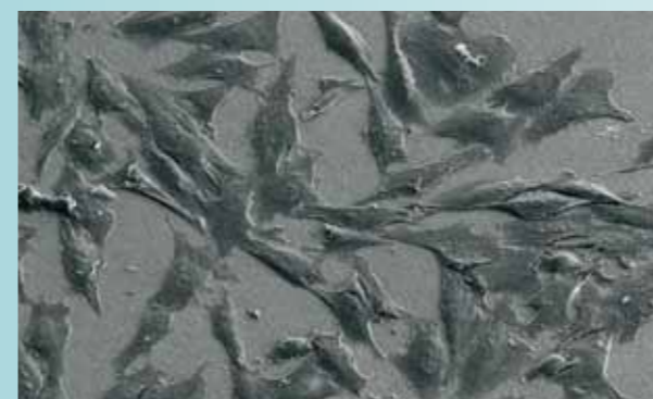
Figura 2. Imagen de microscopía electrónica del cultivo de osteoblastos sobre titanio liso después de 24 horas de incubación. Se observa la morfología plana de los osteoblastos.
