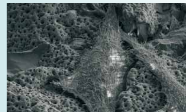
Figura 6. Imagen de microscopía electrónica del cultivo de osteoblastos sobre la superficie AVINENT después de 24 horas de incubación. Se observa la presencia de extensiones citoplasmáticas (filopodios) en el dorso celular.
