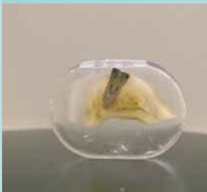
Figura 6. Corte de una muestra incluida en plástico.
