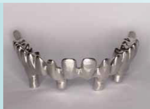
Fig. 5. Estructura de CoCr obtenida con el proceso de fresado PROTECH
