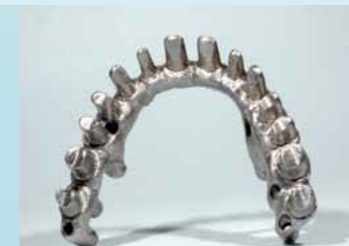
Fig. 3. Estructura realizada mediante tecnología CAD-CAM y fresado HSM
