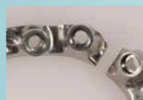
Fig. 8. Detalle del fresado de las conexiones a implante
