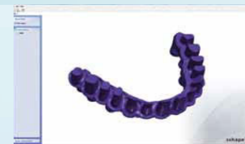
Fig. 2. Modelado CAD de la híbrida con muñones
