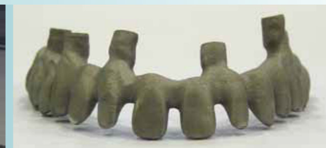
Fig. 10. Estructura obtenida con el proceso de sinterizado
