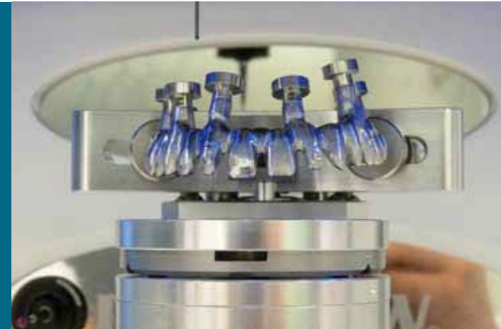
Fig. 12. Escaneado de la estructura mediante localizadores de precisión
