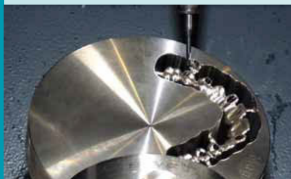
Fig. 4. Detalle de la estructura en el disco de fresado PROTECH
